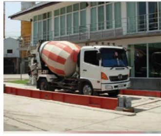
ថាសជញ្ជីងអេឡិចត្រូនិក ប្រភេទ ពាក់កណ្តាលគប់ពាក់កណ្តាលអណ្តែត ម៉ាក LP
