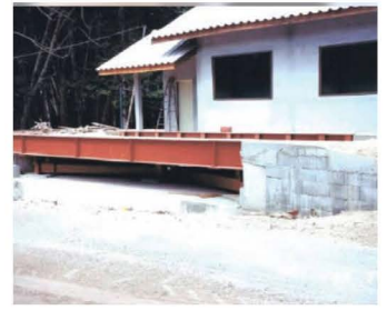
ថាសជញ្ជីងបែបអណ្តែតមេកានិច (ប្រព័ន្ធធនជាមួយទំងន់) ម៉ាក PLM
