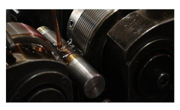
"ลูกธิสเกลียว" ทรงกระบอก (Thread Rolling Cylindrical Dies) (TR) ลูกธิสเกลียวทรงกระบอก (Cylindrical dies) คือการทำเกลียวบนชิ้นงาน ด้วย ลูกธิสเกลียว 2 หรือ 3 ลูก ที่มีลักษณะเหมือนกัน มีแกนคู่ขนานหมุนไปในทิศทาง และความเร็วที่เท่ากัน ชุสลูกธิสเกลียวทรงกระบอกนี้ ใช้พื้นที่น้อย การใช้งาน และ บำรุงรักษาง่าย ซึ่งใช้กันอย่างแพร่หลายสำหรับพู้ประกอบการพลิสสกรู สำหรับลูกรีสเกลียวมี 2 ชนิด ดังนี้
